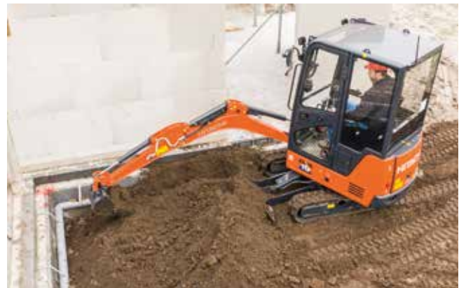
Le petit rayon de braquage minimum avant est idéal pour les espaces exigus.
