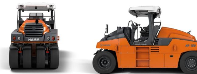
Les compacteurs à pneus de la série HP convainquent dans la pose d'enrobé et le terrassement. Tous les modèles offrent un poste de conducteur spacieux et confortable. Un cadre asymétrique et le design ingénieux de l'engin garantissent une excellente visibilité. Autre atout de taille : un pilotage intuitif, indépendant de la langue. Il facilite le travail des conducteurs et contribue à la sécurité.
