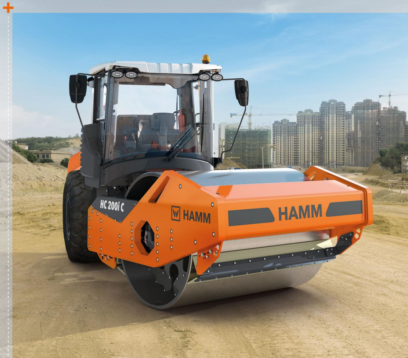
Les compacteurs de la série HC sont des "pros" performants dotés d'une grande force de compactage. Grâce à l'articulation 3 points et aux grands angles de pente à l'avant et à l'arrière, ils sont extrêmement manœuvrables avec une stabilité de conduite optimale. Avec ses interfaces et son matériel, la série HC est prête à répondre aux exigences de qualité et de communication des futurs chantiers.
