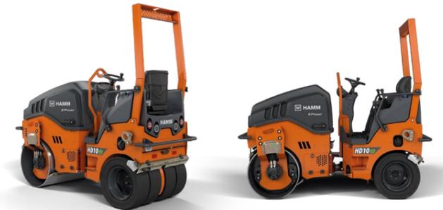
Les huit rouleaux tandem à entraînement entièrement électrique de HAMM sont identiques à leurs homologues à moteur thermique en termes d'utilisation et de capacité de compactage. Grâce à l'entraînement électrique, ils travaillent sur le chantier sans émissions locales et avec des émissions sonores nettement réduites.
