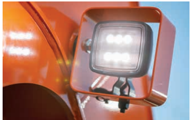
Les lampes DEL ont une durée de vie plus longue que les substituts halogènes.
