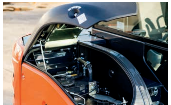
Les capots faciles à ouvrir permettent un accès rapide.
