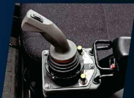
Manœuvrez sur vos chantiers en **totale sécurité**. La MRT Easy est équipée sur le Joystick de gauche de deux **potentiomètres** qui gèrent de façon indépendante la **vitesse de rotation gauche/droite de la tourelle**. En maîtrisant parfaitement la vitesse de rotation, **vous êtes plus précis** dans le placement des charges et **vous gagnez en productivité** sur les sites encombrés sans sacrifier la sécurité.
