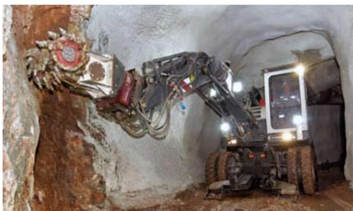
Les fraises hydrauliques et les pelles sur pneus Terex forment des équipes idéales pour les opérations de coupe de précision.
