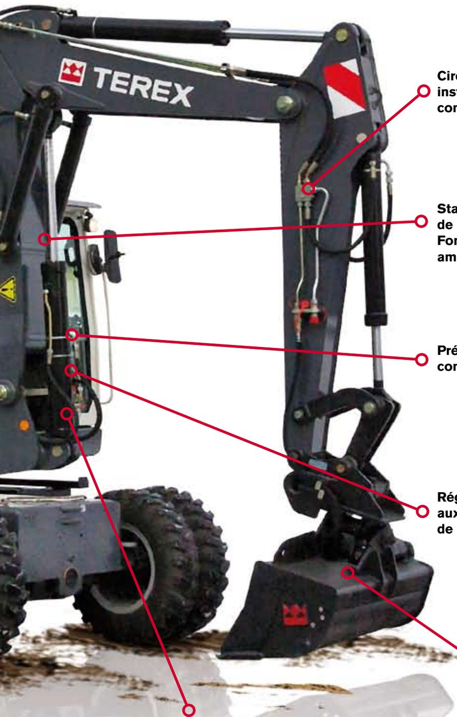
**Circuit hydraulique auxiliaire supplémentaire installé de série pour une compatibilité complète des outils de travail.**
