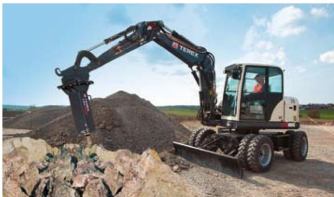
Solution puissante pour les travaux de démolition, avec la possibilité d'utiliser des marteaux hydrauliques, des broyeurs à béton et des grappins.
