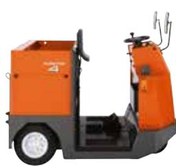
Les modèles CBTY hautes performances offrent des capacités de 4 et 6 tonnes et sont particulièrement adaptés pour les applications sur des pentes
