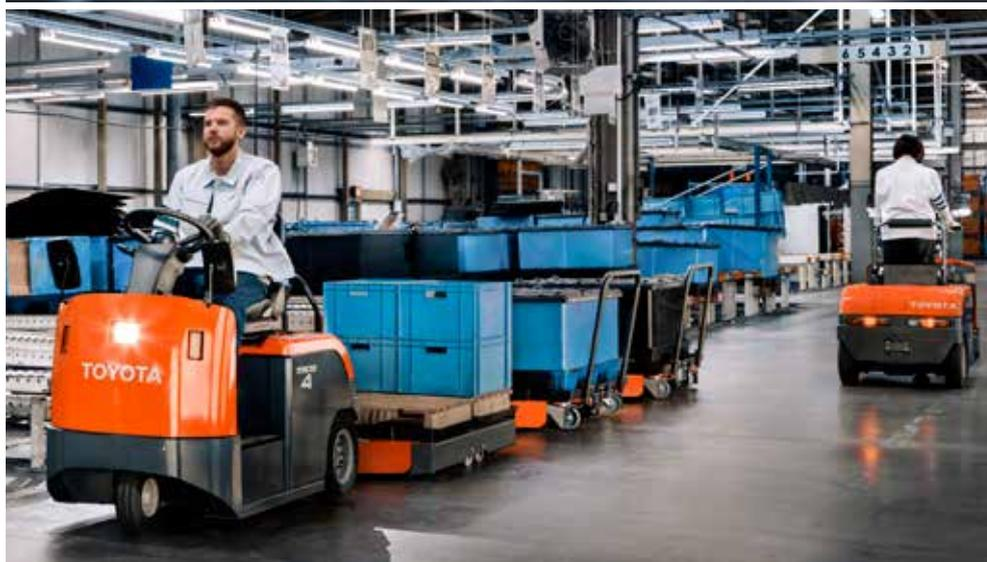
Avec le modèle 4CBTYR, la commande à distance en option permet de déplacer le chariot et de le charger pendant la préparation de commandes et même de le télécommander sur de longs trajets.
