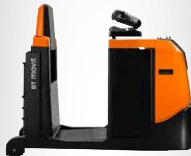
Chariots tracteurs hautes performances, avec montée et descente aisées pour les applications intensives de remorquage et de préparation de commandes
