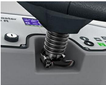
**Volant réglable en hauteur :** le volant peut être ajusté en hauteur pour assurer un travail et une position assise confortable pour le dos.
