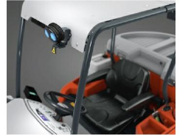
**Toits de protection** : les machines peuvent être équipées d'un toit de protection pour protéger le conducteur contre les chutes d'objets par le haut, par exemple dans les grands entrepôts.
