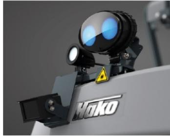
**Équipement de sécurité** : lorsque vous travaillez dans des environnements complexes avec de nombreuses allées, le voyant BlueSpot indique un véhicule en approche avant qu'il ne devienne visible pour les personnes ou les autres véhicules qui traversent. La caméra de recul offre une sécurité supplémentaire.
