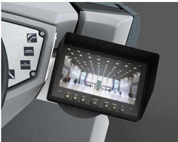
**Système de recul** : la caméra de recul installée à l'arrière de la machine et l'écran à côté du panneau de commande offrent une vision optimale à l'arrière.
