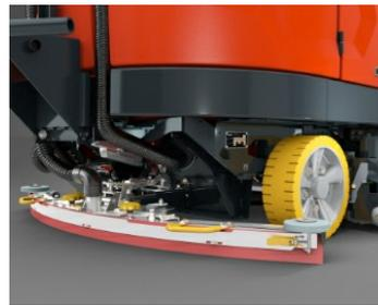
**Suceur avec lavage automatique :** le suceur peut être automatiquement nettoyé pour faciliter le travail de l'opérateur. De plus, il est aussi escamotable pour un lavage en profondeur.
