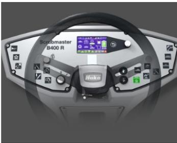
**Tout en un coup d'œil :** le panneau de commande avec écran LCD facile à utiliser avec un bouton de réinitialisation de la machine. Le système d'exploitation à un bouton démarre toutes les principales fonctions de nettoyage d'une simple pression.
