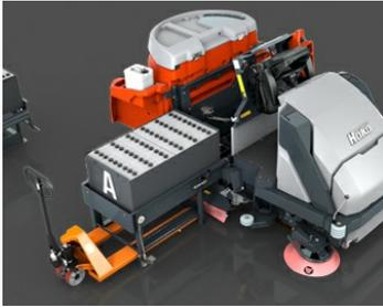
**Système de changement de la batterie** : (en option) maximise la capacité de la batterie pour permettre une autonomie prolongée. Le changement des batteries est simple et simple, aucun outil n'est requis. [Cliquez ici pour regarder la vidéo!](#)
