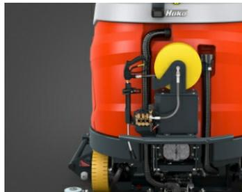
**Nettoyeur haute pression** : le nettoyeur haute pression embarqué avec alimentation intégrée fournit une pression de 120 bars à 6l/ min pour nettoyer tous les murs et recoins.
