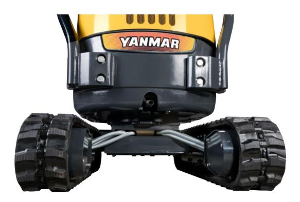
La mini-pelle ViO12 a un poids opérationnel de 1 235 kg et le châssis le plus long de sa catégorie avec 1 440 mm. Par conséquent, l'opérateur voit une réelle amélioration de son confort. Le maniement de la pelle se fait sans à-coups et la productivité est accrue. La machine est également plus stable lors du déplacement de charges lourdes ou quand elle est équipée d'accessoires supplémentaires. C'est un atout fondamental pour les applications clés de ce type de machine telles que la démolition.
