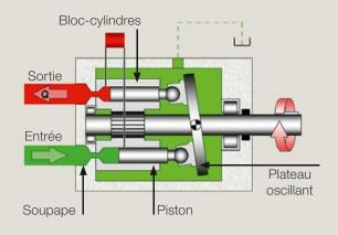
Contrairement aux standards pour cette catégorie de pelles, Yanmar utilise une pompe à pistons à débit variable qui régule le débit et la pression en fonction de la charge. Ainsi, le fonctionnement est plus fluide et l'opérateur bénéficie d'un plus grand confort. La pompe a un débit de 2 x 11 l/min et une pression de service élevée (210 bars) qui permet également d'augmenter la productivité de la pelle et sa vitesse pendant les déplacements.
