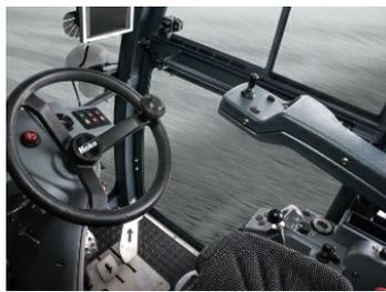
**Plus de souplesse pour le balayage et le désherbage** : la balayeuse classique Hako peut désormais être équipée en option d'un système de commande individuelle des balais et de réglage de la tête du côté droit.
