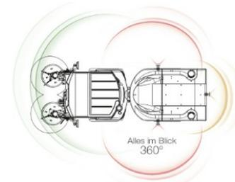
**Une excellente visibilité :** les systèmes de caméra disponibles en option permettent d'élargir le champ de visibilité à 360° : une meilleure sécurité et des risques de collision réduits.
