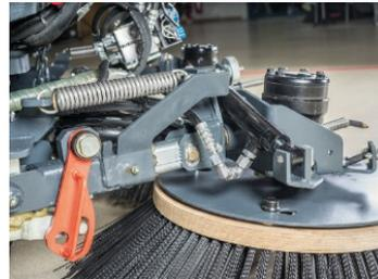
**Adaptation à tous les travaux de balayage** grâce au réglage hydraulique des têtes de balai (option).
