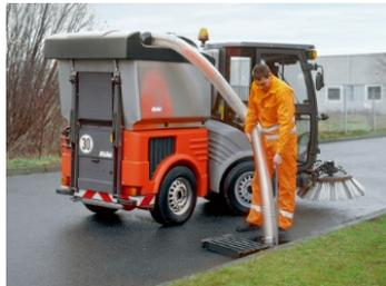
**Tuyau d'aspiration à la main :** même les endroits les moins accessibles autour de la machine peuvent être nettoyés facilement.
