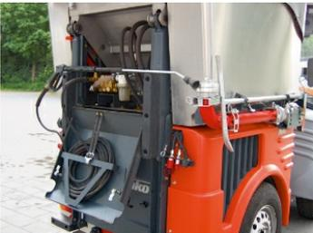
**Grande souplesse d'utilisation** grâce à une gamme d'accessoires disponibles en option tels que raccords d'alimentation en eau, un tuyau de remplissage ou un nettoyeur haute pression intégré.
