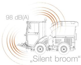
**Un balayage tout en silence :** la balayeuse de voirie Citymaster 1250plus peut être équipée de « balais silencieux » pour travailler à un niveau sonore réduit à 98 dB(A) au maximum.
