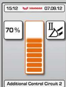
Ajustement proportionnel électrique de la performance hydraulique des 3<sup>e</sup> et 4<sup>e</sup> circuits.
